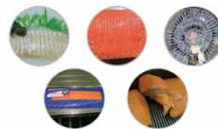
GB 134, 136 – автоматические слайсеры предназначены для косой нарезки рыбного филе и мясных продуктов.
